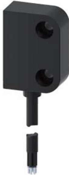
Magnetschalter Schaltelement, rechteckig klein 26 x 36 mm, für Türanschlag links, Schaltglieder: Sicherheitskontakte 2Ö Meldekontakt 1Ö mit 3 m Anschlusskabel ohne LED, der dazu passende Schaltmagnet 3SE6714-3CA Schaltmagnet 3SE6714-3CA oder um 90° versetzt 3SE6724-3CA
