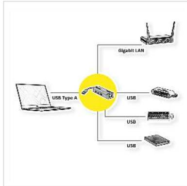
**Avec ce convertisseur, vous pouvez connecter votre PC ou ordinateur portable avec interface USB 3.0 / USB 3.2 Gen 1 à un réseau Gigabit Ethernet. Et vous pouvez en même temps connecter d'autres appareils à votre PC ou ordinateur portable via USB.**
