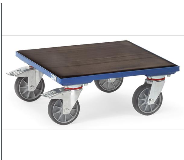
Plateau roulant en profilé d'acier avec plateau bois recouvert de TPE antidérapant, revêtement époxy bleu RAL 5007, 4 roues pivotantes à bandage TPE 125 x 32, moyeu à roulement à billes central. 2 roues avec freins conformément à la Norme EN 1757-3.
