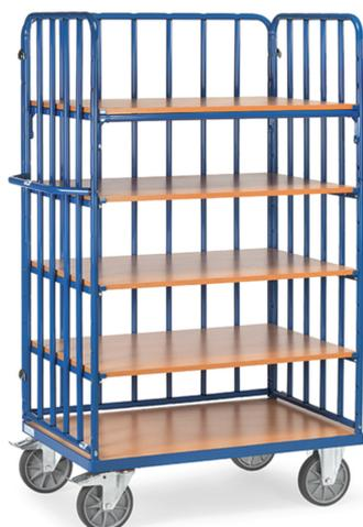
Ensemble mécano-soudé, revêtement époxy bleu RAL 5007. 1 plateau fixe et 4 amovibles en mélaminé surface effet hêtre. Ridelles avec tubes verticaux distancés de 130 mm. Plateaux réglables au pas de 100 mm. Charge maximum par plateau : 90 kg. 2 roues pivotantes et 2 roues fixes à bandage TPE, moyeu à roulement à billes central. Freins sur roues pivotantes conformément à la Norme 1757-3 (Sécurité des chariots de manutention).
