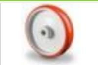
roue, force 150 kg, diamètre x largeur 125 x 32 mm, moyeu longueur x Ø 44 x 15 mm, avec bandage polyuréthane, moyeu avec roulement à rouleaux, jante en plastique
