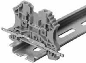
Mit dem LS 2.8 WDU2.5-10 lassen sich viele Durchgangsreihenklemmen aus der W-Reihe ganz einfach umrüsten. Das Einlegen des LS 2.8 WDU2.5-10 ermöglicht es das Leitungsschirmgeflecht direkt an der Reihenklemme durch Anlöten oder mittels geeigneter Flachkabelschuh durchzuschleifen.
