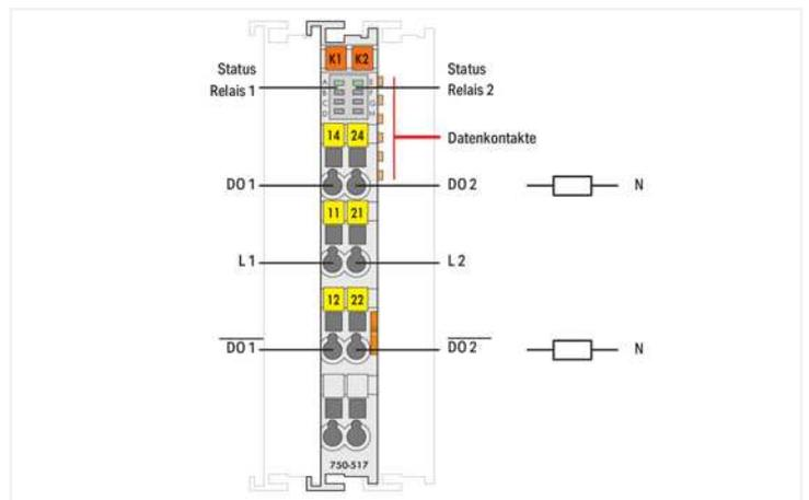
Über das Digitalausgangsmodul werden Steuersignale aus dem Automatisierungsgerät an die angeschlossenen Aktoren weitergegeben. Zur Ansteuerung der Relais wird die interne Systemspannung genutzt. Die Kontakte sind potentialfrei angeordnet. Der Ansteuerungszustand des Relais wird über LED signalisiert.
