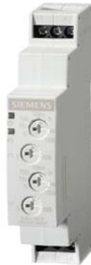
Zeitrelais, elektronisch Taktgeber, 1 Wechsler 7 Zeitbereiche 0,05 s... 100 h AC/DC 12...240 V mit LED, Schraubanschluss
