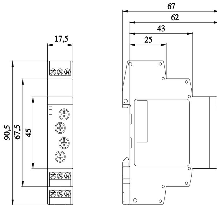
Alle Bemessungswerte sind in Millimeter (mm) angegeben
