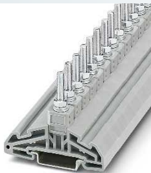
16 (16) mm 2 , 76 A, M5 Bolzenklemme
