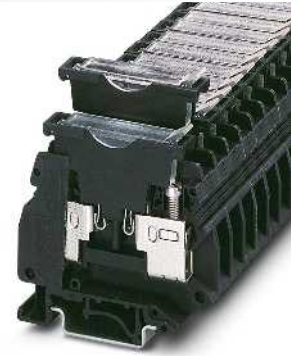
16 (16) mm 2 , 40 A, Sicherungs-Grundklemme für G-Sicherungsstecker oder Trennstecker
