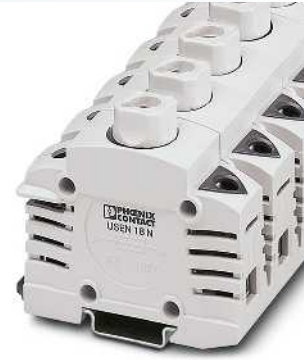
35 (35) mm 2 , 63 A, Sicherungsklemme für NEOZED D 02 (E18)
