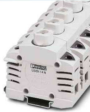
35 (35) mm 2 , 16 A, Sicherungsklemme für NEOZED D 01 (E14)
