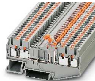
20 A, Messertrennklemme, 4 Anschlüsse, 2 Funktionsschächte
