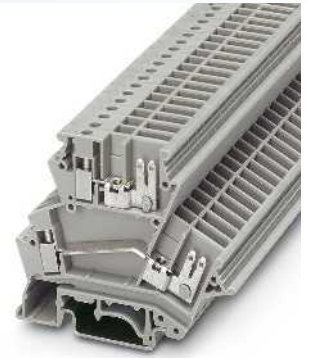
4 (4) mm 2 , 20 A, Doppelstockklemme mit Schraub- und Flachsteckanschluss
