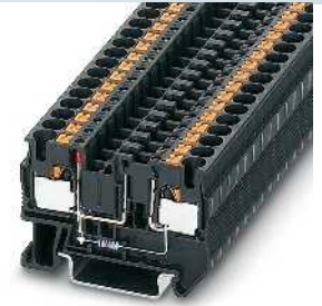
15 A, Sicherungsklemme mit Leuchtanzeige, für Flachsicherungen Typ F
