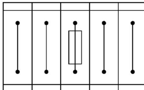
Morsetti portafusibili in disposizione singola, con il blocco composto da un morsetto portafusibile e 4 morsetti passanti
