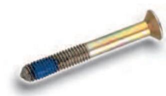
Fig.44. La pastilla adhesiva aplicada en la rosca pierde gran parte de sus propiedades bloqueantes y se deteriora cuando está sometida a altas temperaturas. El tornillo no es reutilizable y el coste de aplicación es elevado.
