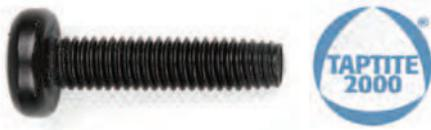
Los tornillos rosca TAPTITE 2000® incorporan un nuevo diseño de filete de perfil radial y una trilobularidad optimizada que mejora el proceso de formación de rosca y refuerza la unión, incrementando la resistencia al aflojado por vibraciones.
