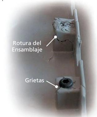
Fig. 7. Rotura de manguitos ocasionadas por el roscado de un tornillo rosca chapa sobre un pieza de poliéster + 30% Fibra de Vidrio.
