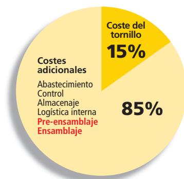
Únicamente el 15% del total de los costes de ensamblaje corresponden al coste directo del tornillo. Los tornillos de rosca TRILOBULAR TAPTITE® han sido especialmente diseñados para reducir significativamente el 85% restante.
