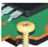
Para el ensamblaje sobre materiales termoplásticos con carga de fibra de vidrio, y módulos de flexión comprendidos entre 30.000 y 80.000 kg/cm<sup>2</sup>. Está recomendado para aplicaciones en agujeros de poca profundidad con elevados requerimientos de resistencia a la tracción.
