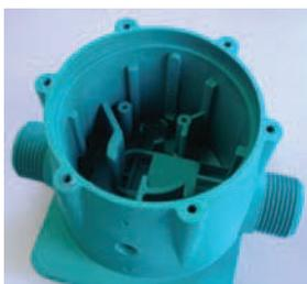
Fig.12. Bomba de agua (PA+ 50% GF)
