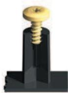
Los tornillos rosca CELOPLAST se recomiendan para el ensamblaje sobre materiales termoplásticos de módulo de flexión comprendidos entre 500 y 30.000 kg/cm<sup>2</sup>. La Profundidad de ensamblaje requerida entre 1,5 y 3 veces el diámetro del tornillo.
