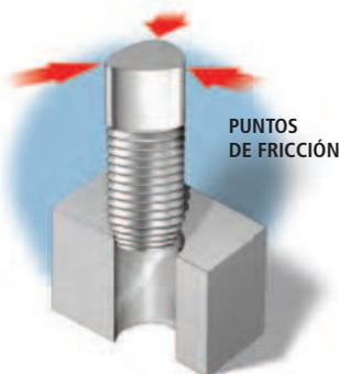
Los tornillos de sección TRILOBULAR TAPTITE® tienen un perfil de rosca parecido al de la rosca métrica, con un ángulo de filete de 60° y paso de rosca métrica, pero con sección TRILOBULAR (tres lóbulos).
