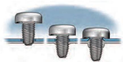
Fig.48. La punta especial provoca una extrusión en la chapa durante el proceso de roscado, aumentando la longitud de ensamblaje y por lo tanto, la resistencia a la tracción.
