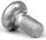
El sistema de clipado **CELOSTAMP®** es una solución para la fijación de tornillos sobre chapa de acero o aluminio de reducido espesor. Es una alternativa de alta calidad a la soldadura en los casos en los que ésta no es posible o deseable, por ejemplo en la unión de materiales diferentes, chapas con recubrimientos especiales, uniones sensibles a temperatura...
