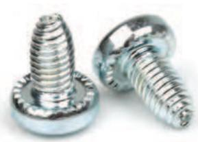
Los tornillos rosca **FASTITE® 2000™** han sido especialmente desarrollados para el ensamblaje sobre **chapas de reducido espesor** (hasta 1/3 del diámetro nominal del tornillo), garantizando la compresión del ensamblaje sin riesgo de pasado de rosca y proporcionando una excelente resistencia a la tracción y al aflojado por vibración.
