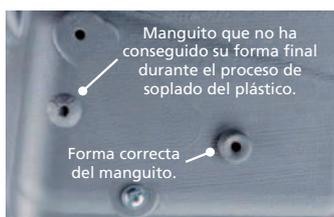
Fig.26. Problemas de fluidez del plástico en los manguitos para piezas de plástico soplado. La utilización de tornillo TWINPLAST evita la necesidad de diseñar manguitos y asegura la fijación en piezas de plástico soplado.
