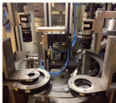
La SELECCIÓN ÓPTICA es un proceso de inspección automática del 100% de las piezas del lote de fabricación que nos permite detectar desviaciones en las dimensiones de la cabeza, vástago y rosca. Mediante este sistema de inspección se garantiza la conformidad de las piezas dentro de los parámetros de control establecidos y de acuerdo a las especificaciones acordadas.
