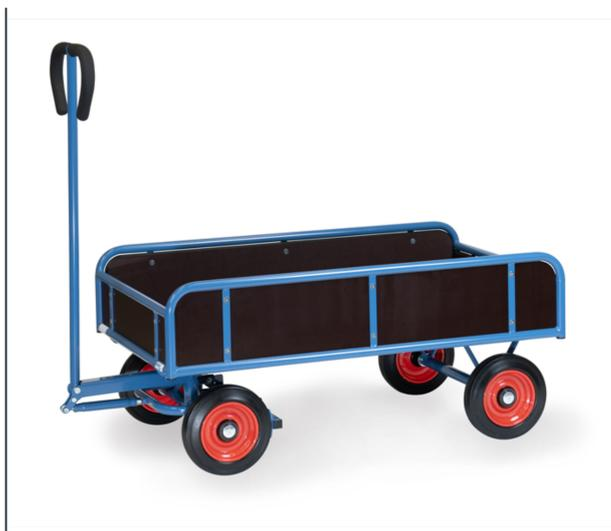
En tube d'acier soudé, revêtement époxy bleu RAL 5007. Ridelles hauteur 250 mm, Plateau et ridelles en contreplaqué hydrofuge. Essieu avec timon. Roues à bandage caoutchouc, moyeu à roulement à rouleaux. Poignée sécurisée avec revêtement souple remontant automatiquement en position verticale. Blocage automatique de l'essieu avant, conformément à la Norme EN 1757-3.
