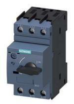
Sondertyp Leistungsschalter Baugröße S00 für den Motorschutz, CLASS 10 A-Auslöser 2,8...4 A N-Auslöser 52 A Schraubanschluss Standardschaltvermögen Umgebungstemperatur -50 °C 500 Schaltspiele
