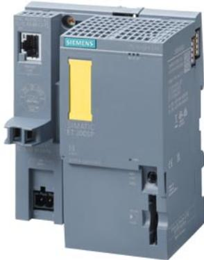
SIMATIC DP, CPU 1514SP F-2 PN für ET 200SP, Zentralbaugruppe mit Arbeitsspeicher 900 KB für Programm und 3,5 MB für Daten, 1. Schnittstelle: PROFINET IRT mit 2 Port Switch, 2. Schnittstelle: PROFINET RT, 6 ns Bit-Performance, SIMATIC Memory Card notwendig, Busadapter notwendig für 1. Schnittstelle \*\*\*\* Zulassungen und Zertifikate gemäß Beitrag 109818872 auf support.industry.siemens.com beachten! \*\*\*\*
