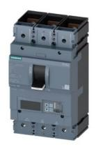
Leistungsschalter 3VA2 IEC Frame 630 Schaltvermögenklasse M Icu=55kA @ 415V 3-polig, Anlagenschutz ETU560, LSIG, In=500A Überlastschutz Ir=200A...500A Kurzschlussschutz Isd=0,6..10x In, Ii=1,5..14x In N-Leiterschutz optional mit externem Stromwandler, bis 160% Erdschlussschutz, abschaltbar Ig=0,2...1 x In, tg=0,05-0,8s Schraubenflachanschluss
