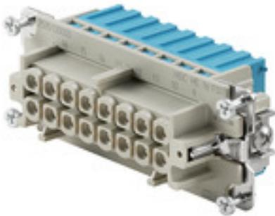
Bei dem Quick-Termination Anschluss ist die Leiteranschlussebene bereits geöffnet und der abisolierte Leiter kann einfach eingesteckt werden. In der Endposition schliesst der patentierte Klemmmechanismus automatisch. Dadurch ist sie praktisch wartungsfrei und es besteht eine sichere und dauerhafte Verbindung, welche rüttelfest ausgelegt ist. Weidmüller bietet somit als erster und einziger Hersteller diese neuartige Anslusstechnik.
