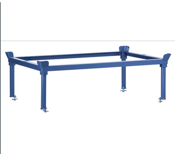
Zum Abstellen von Flachpaletten und Gitterboxen in ergonomisch günstiger Höhe. Winkelstahl-Schweißkonstruktion, mit Fangecken, stabile Stützrohre mit Fußplatten, einsteckbar in Eckhülsen am Aufsetzrahmen. Pulverbeschichtet, blau RAL 5007. Über die Fußplatten sind die Aufsetzrahmen mittels Verschraubungssatz (im Lieferumfang enthalten) fest mit dem Paletten-Fahrgestell verschraubbar.
