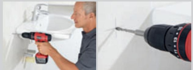
*Absolut präzises Anbohren. Die Hartmetall-Bohrspitze bricht beim Ansetzen die Oberflächenbeschichtung auf und verhindert ein Verlaufen des Bohrers. Für höchste Standzeit und langlebige Verbindung sorgt die vacuumverschweißte Hartmetallschneide.*
