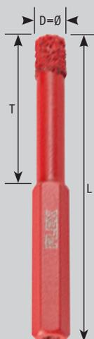
*Der Hohlchaft verringert das Gewicht und speichert das Kühlmittel. Sechskantschaft SW zur Aufnahme in 13mm Bohrfutter, schützt vor Überdrehen im Bohrfutter und Beschädigungen am Schaft. Die drei Spannbacken des Bohrfutters liegen vollflächig an den Spannflächen an und sorgen für besten Halt.*
