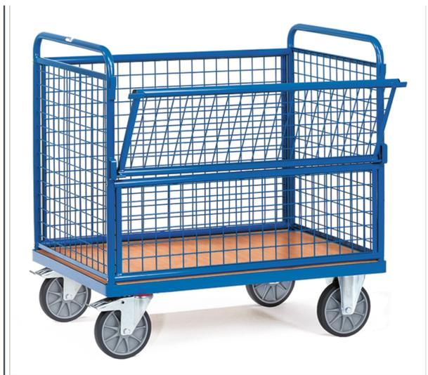
Ensemble mécano-soudé, revêtement époxy bleu RAL 5007. Habillage en treillis métallique 50 x 50 x 4 mm, avec plateau en mélaminé surface effet hêtre. 2 roues pivotantes et 2 roues fixes à bandage TPE, moyeu à roulement à billes central. Freins sur roues pivotantes conformément à la Norme Européenne 1757-3 (Sécurité des chariots de manutention).
