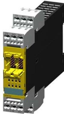
SIRIUS, Erweiterungsmodul 3RK32 für modulares Sicherheitssystem 3RK3 4/8 F-DI, DC 24 V parametrierbar über MSS ES 22,5 mm Baubreite Federzugklemme bis SIL3 (IEC 61508) bis Performance Level E (ISO 13849-1) ohne Verbindungskabel
