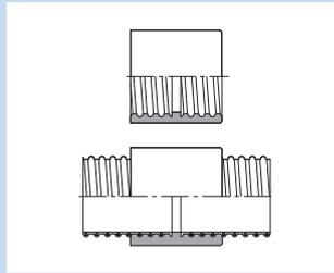
Raccord de tuyau spiralé pour le raccordement, l'allongement ou la réparation de tuyau spiralé
