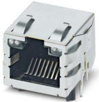
RJ45-Leiterplatten-Steckverbinder, Bauform: RJ45, Schutzart: IP20, Polzahl: 8, 10 GBit/s, Material: Metall, Anschlussart: THR-Reflow / THT-Welle, kurze Lötkontakte
