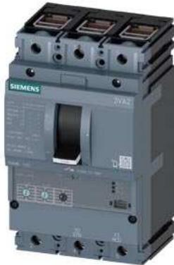
Leistungsschalter 3VA2 IEC Frame 100 Schaltvermögenklasse L Icu=150kA @ 415V 3-polig, Anlagenschutz ETU320, LI, In=100A Überlastschutz Ir=40A...100A Kurzschlusschutz Ii=1,5...12 x In Klemmenanschluss
