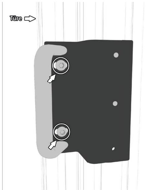
Abb.6: Montageplatte mit Ankerplatte am Profil anbringen und zur Prozesszuhalterung ausrichten. Schrauben M8 x 12 mm Torx festziehen.
