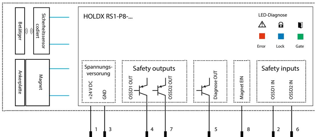
Abb.13: HOLDX RS1 Standalone 8-polig Pigtail ohne Reset-Funktion
