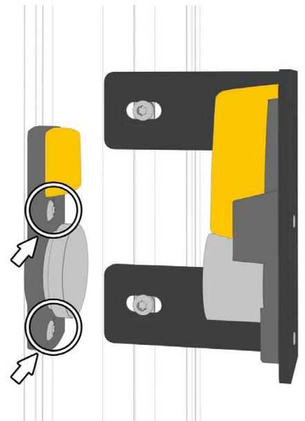
Abb.9: Ankerplatte am Profil der Schiebetüre anbringen, zur Prozesszuhalterung ausrichten und zur Prozesszuhalterung ausrichten. Schrauben M6 x 16 mm Torx festziehen.
