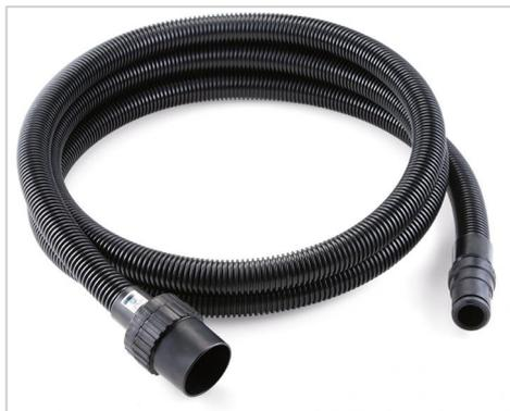
Innen-Ø 27 mm, 3,5 m mit flexibler Gummi-Muffe für den Anschluss an Elektrowerkzeuge, antistatisch. Passend für alle Sauger der VCE 33 und 44 Klasse sowie für VC 21 und VCE 26.
