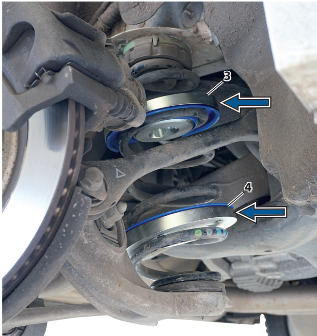
📷6: Druckplatten "3 + 4" in die Feder einlegen.
