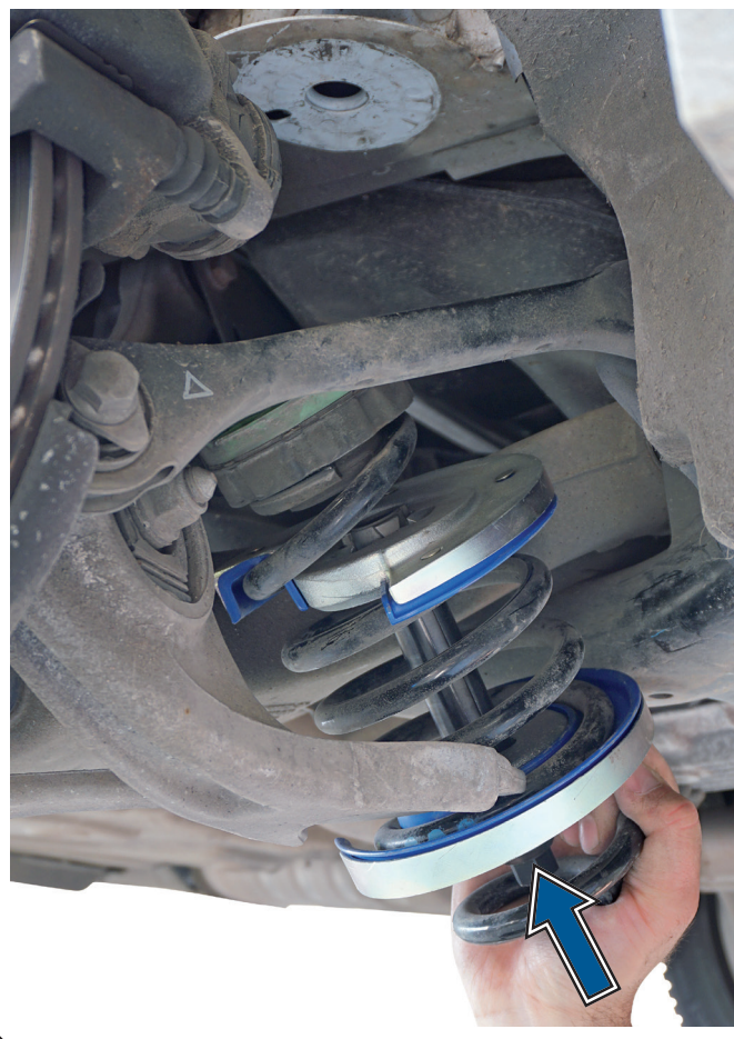
📸 17: Gespannte Feder in die Achse einsetzen.
