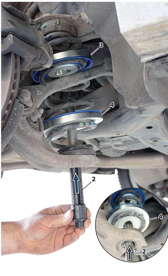
📷7: Spannzylinder "2" einsetzen und arretieren.
