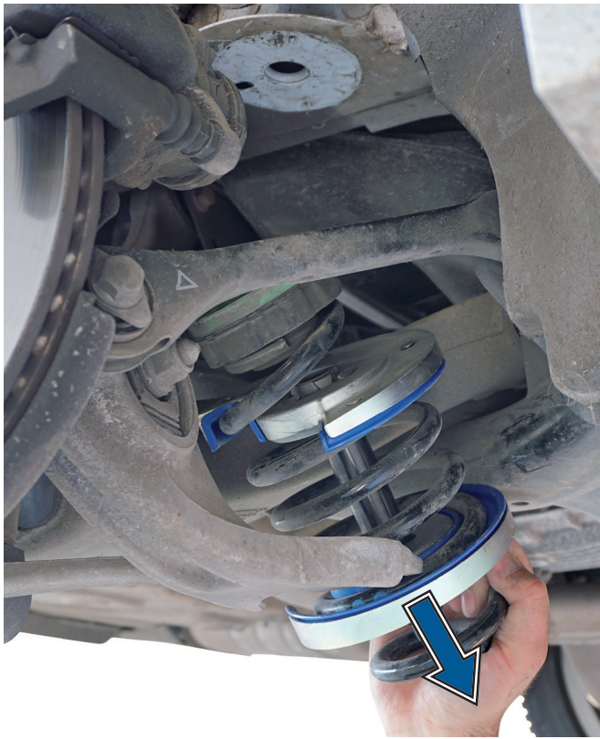
📷 11: Position der Druckplatten an der Feder markieren.
