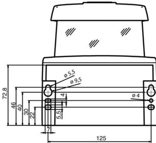
Minimaler Platzbedarf zur Montage und zum Austausch der Scannereinheit
