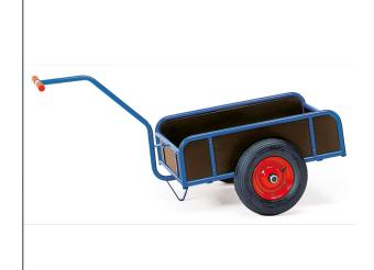
Handwagen aus Stahlrohr geschweißt, pulverbeschichtet, brillantblau RAL 5007. Deichsel anschraubbar, Ladefläche aus wasserfestem Sperrholz. Mit 4 Wänden aus wasserfestem Sperrholz, 180/250 mm hoch. Räder mit Luftbereifung, Naben mit Rollenlager.
