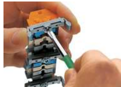
Klemmenleiste; mit Befestigungsflanschen, Anschrauben des Montagefußes (209-123) (Der Abstand der Montagefüße zueinander unter einer Klemmenleiste soll ca. 25 ... 30 mm betragen.)
