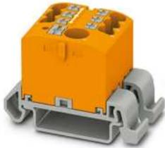
Verteilerblock, die Blöcke sind untereinander über den Leiterschacht brückbar, passende Steckbrücken siehe Zubehör, Block mit waagerechter Ausrichtung und integrierter Einspeisung, Nennspannung: 690 V, Nennstrom: 41 A, Anschlussart: Push-in-Anschluss, Sammelschluss, Bemessungsquerschnitt: 6 mm<sup>2</sup>, Querschnitt: 0,5 mm<sup>2</sup> - 10 mm<sup>2</sup>, Push-in-Anschluss, Abgriff, Querschnitt: 0,14 mm<sup>2</sup> - 4 mm<sup>2</sup>, Montageart: NS 35/7,5, NS 35/15, Farbe: orange
