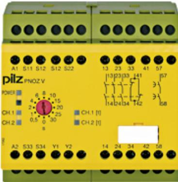
Sicherheitsschaltgerät (standalone), Eingänge: 1/2-kanalige Beschaltung ohne Querschlusserkennung, Ausgänge: 3 S, 1 Ö, 1 Sz, automatischer/ manueller Start, UB = 24 V DC, Breite: 90 mm, Schraubklemmen integriert, Überwachung von Not-Halt, Schutztüren, mit einem rückfallverzögertem Kontakt, Verzögerungszeit einstellbar in 12 Stufen von 0,05 - 30 s.
