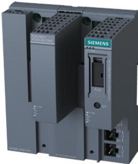
SCALANCE XF204 DNA managed IE Y-Switch, IEC 62443-4-2 zertifiziert; Zwei Busadapter BA 2xRJ45 HA vormontiert 6DL1193-6AR00-0AA0 4 x 10/100Mbit/s, 2 x Busadapter-Schnittstelle, Fehlermeldekontakt, Set-Taster, redundante 24V DC Spannungsversorgung, PROFINET-Device, erweiterter Temperaturbereich -40°C...+70°C, Conformal Coating, mit elektron. Handbuch auf DVD, C-PLUG optional, Lieferung mit Busadapter
