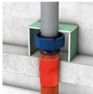
Die Abschottung CurafLAM® Konfix<sup>Pro</sup> (ggf. inkl. weiterer Rohrleitungen) muss hinter einer Vorsatzschale aus mindestens 9,5 mm dicken nicht-brennbaren zement- bzw. gipsgebundenen Bauplatten (z. B. Gipskartonbauplatten) oder in mindestens 50 mm dicker Massivbauweise verkleidet sein.
