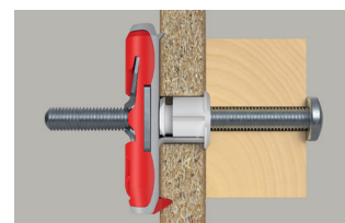
Idealer Kippdübel für alle Plattenbaustoff mit hoher Tragfähigkeit.
