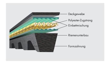
Der Riemenunterbau besteht aus einer Polychloropren-Gummimischung mit quer zur Laufrichtung ausgerichteten Fasern, die den Zugstrang wirksam abstützen.
