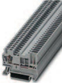
Durchgangsklemme, Anschlussart: Zugfeder- / Steckanschluss, Querschnitt: 0,08 mm<sup>2</sup> - 4 mm<sup>2</sup>, AWG: 28 - 12, Breite: 5,2 mm, Farbe: grau, Montageart: NS 35/7,5, NS 35/15
