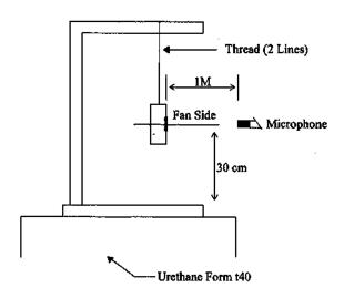
1 METER FROM MICROPHONE TO FAN INTAKE
