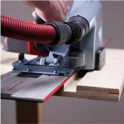
Mit dem Verstellnuter MF-VN 25 können Nuten für Stellbretter oder Versorgungsleitungen effektiv und schnell eingefräst werden.
