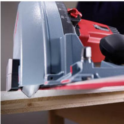
Mit dem Gipskartonfräser MF-GF 90 lassen sich 90°-V-Nuten staubarm fräsen, damit kann eine stabile Eckverkleidung hergestellt werden.
