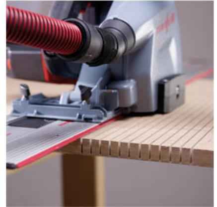
3 Schlitz pro Abreitsgang mit dem MF-SE 3. Mit dieser Biegetechnik lassen sich schnell und einfach gebogene Werkstücke herstellen.
