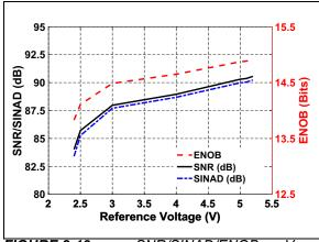
FIGURE 2-13: SNR/SINAD/ENOB vs. V<sub>REF</sub>
