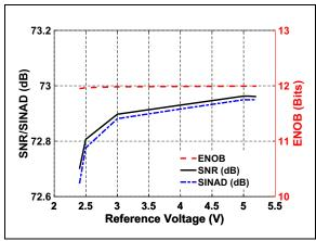
FIGURE 4-13: SNR/SINAD/ENOB vs. V<sub>REF</sub>
