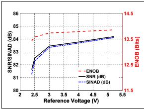
FIGURE 3-13: SNR/SINAD/ENOB vs. V<sub>REF</sub>
