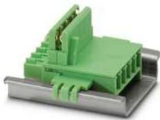
Tragschienen-Busverbinder, Farbe: grün, Nennstrom: 8 A (parallele Kontakte), Bemessungsspannung (III/2): 125 V, Polzahl: 5, Rastermaß: 3,81 mm, Montage: Tragschienenmontage, Verriegelung: ohne, Befestigungsart: ohne, Verpackungsart: verpackt im Karton, Artikel mit vergoldeten Kontakten, Busstecker zur Verbindung mit Elektronikgehäusen, 5 Parallelkontakte
