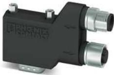
D-SUB-Stecker, 9-polig, Stift, Belegung: 3, 5, 6, 8; zwei M12-Kabelzuführungen (B-kodiert) unter 90°. Bussystem: PROFIBUS DP bis 12 MBit/s. Abschlusswiderstand über separaten M12-Terminator.
