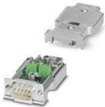
D-SUB-Stecker, 9-polig, Stift, axiale Ausführung mit zwei Kabelzuführungen, Bussystem: PROFIBUS DP bis 12 MBit/s, Abschlusswiderstand über Schiebeschalter zuschaltbar, Pinbelegung: 3, 5, 6, 8; Schraubanschlussklemmen
