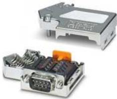
D-SUB-Stecker, 9-polig, Stift, Kabelzuführung unter 35°, Bussystem: PROFIBUS DP bis 12 MBit/s, Abschlusswiderstand über Schiebeschalter zuschaltbar, Pinbelegung: 3, 5, 6, 8; Schraubanschlussklemmen
