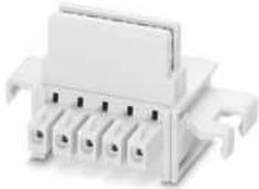
Tragschienen-Busverbinder, Farbe: lichtgrau, Nennstrom: 8 A (parallele Kontakte), Bemessungsspannung (III/2): 125 V, Polzahl: 5, Rastermaß: 3,81 mm, Montage: Tragschienenmontage, Verriegelung: ohne, Befestigungsart: ohne, Verpackungsart: verpackt im Karton, Artikel mit vergoldeten Kontakten, Busstecker zur Verbindung mit Elektronikgehäusen, 5 Parallelkontakte
