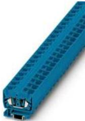
Minidurchgangsklemme, Nennspannung: 800 V, Nennstrom: 24 A, Anschlussart: Zugfederanschluss, 1. Etage, Bemessungsquerschnitt: 2,5 mm<sup>2</sup>, Querschnitt: 0,08 mm<sup>2</sup> - 4 mm<sup>2</sup>, Montageart: NS 15, Farbe: blau
