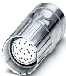
Kabelsteckverbinder, CA, gerade, geschirmt: ja, Schraubverriegelung, M23, Polzahl: 12, Drehsinn: Standard, Kontaktart: Buchse, Lötanschluss, Kabeldurchmesserbereich: 3 mm ... 14,5 mm, Kodierung:N
