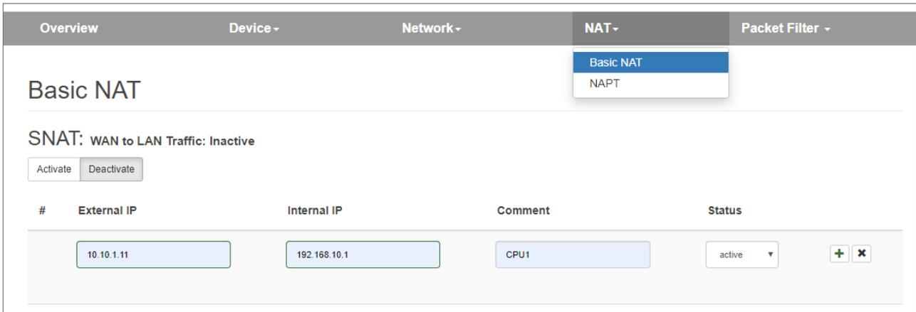
Die „External IP“ ist eine freie IP-Adresse aus dem WAN IP-Adressbereich. Diese darf noch keinem anderen Ethernet Teilnehmer (im WAN) zugewiesen worden sein! Die „Internal IP“ ist die vorhandene IP-Adresse des Netzwerkteilnehmers in der Maschine (LAN). Als Kommentar kann ein beliebiger Text eingegeben werden. Mit dieser ‚zusätzlichen WAN-Schnittstelle‘ wird im WALL IE dann die Adressumsetzung („natting“) zur eingetragenen LAN-IP (dem Zielgerät) realisiert.
