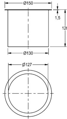
Abwurfhülse, für Waschtischeinbau, Chromnickelstahl, sichtbare Oberfläche seidenmatt, mit gebördeltem Rand, Öffnung mit 127 mm Innendurchmesser, ohne Abfallbehälter.
