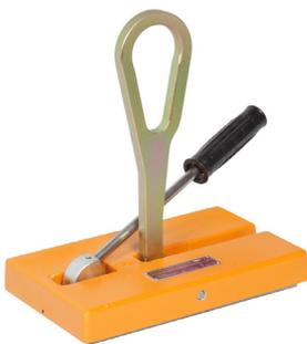
Die REMA MK-250KS und MK-500KS Kranmagnete sind zum Heben und Transportieren von Stahlplatten in horizontaler und vertikaler Lage vorgesehen, wobei die Platten gedreht werden können.
