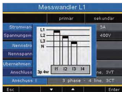
Abb.: Beispiel für die Konfiguration Strommessung über 3 Stromwandler in einem Dreiphasen 4 Leiter Netz am UMG 508 Display
