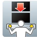
Sicheres Bedienen durch Zweihandschaltungen – Einsatzgebiet bei gefährbringenden Maschinenbewegungen, wie z.B. Pressen, Stanzen, Scheren
