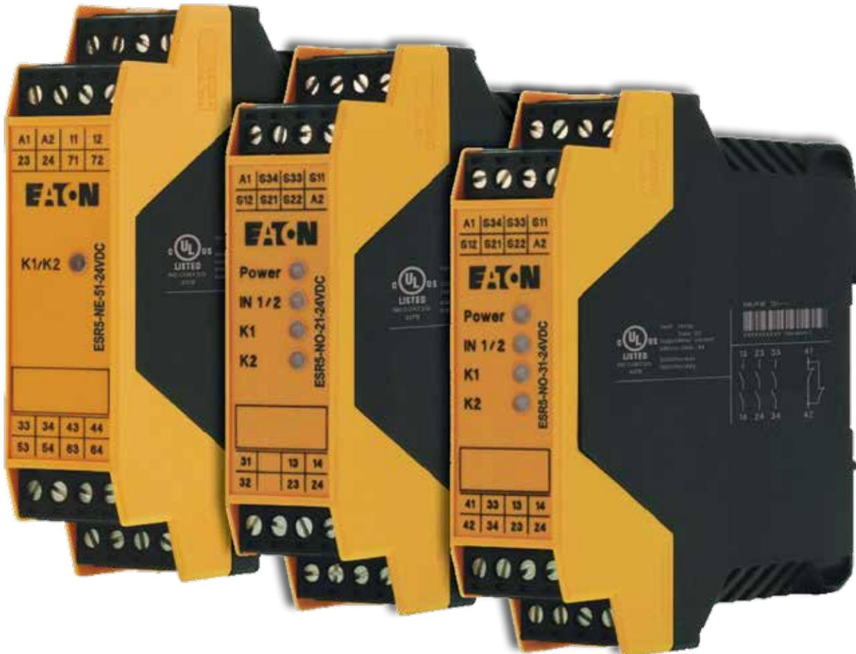
Die Sicherheitsrelais ESR5 überwachen zuverlässig die Signale von Sicherheitseinrichtungen und schalten im Notfall zuverlässig und schnell ab. Die interne Logik der Sicherheitsrelais überwacht die verdrahteten Sicherheitskreise und aktiviert im fehlerfreien Zustand die Freigabepfade.
