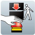
Stillsetzen im Notfall (NOT-AUS und Not-Halt-Abschaltung) – Sicheres Stoppen einer gefährbringenden Bewegung mit Not-Halt-Einrichtungen
