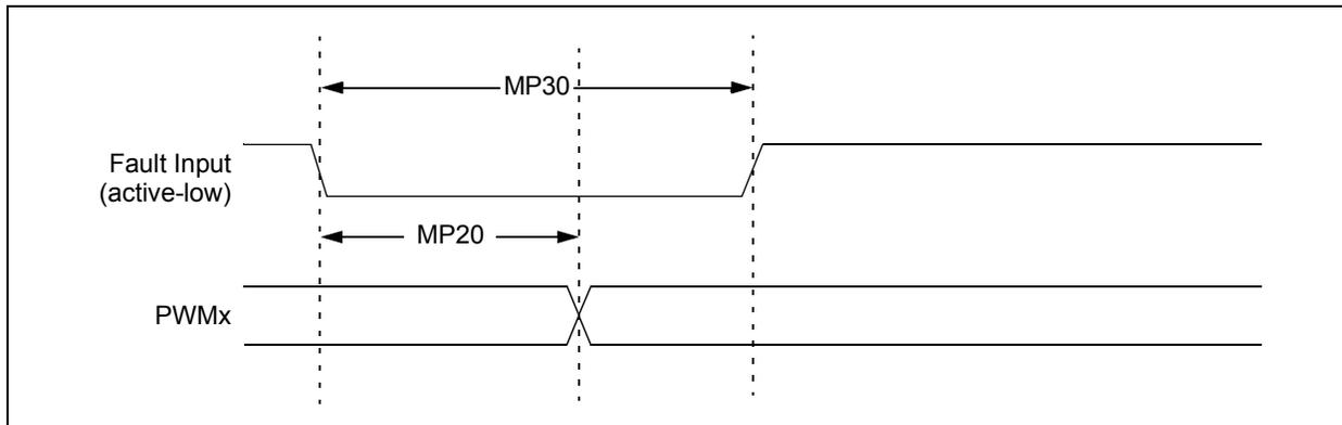
**FIGURE 25-10: HIGH-SPEED PWMx MODULE TIMING CHARACTERISTICS**
