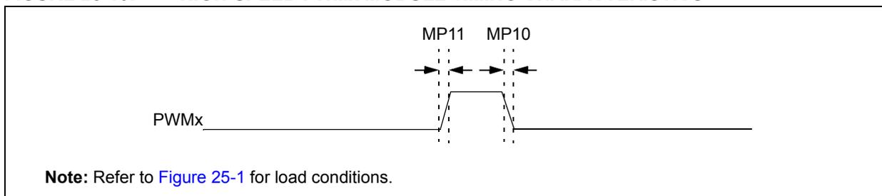
**TABLE 25-30: HIGH-SPEED PWMx MODULE TIMING REQUIREMENTS**
