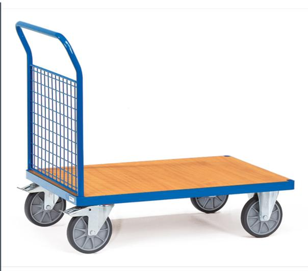
Stahlrohr und Profilstahl geschweißt, pulverbeschichtet RAL 5007, Plattform Holzwerkstoffplatte, Oberfläche Buchendekor. Stirnwand aus Drahtgitter 50 x 50 x 4 mm, Wand 500 mm hoch. 2 Lenk- und 2 Bockrollen, TPE-Bereifung, Naben mit Rillenkugellager. Feststeller an den Lenkrollen, gemäß der Europäischen Norm EN 1757-3 (Sicherheit von Plattformwagen).
