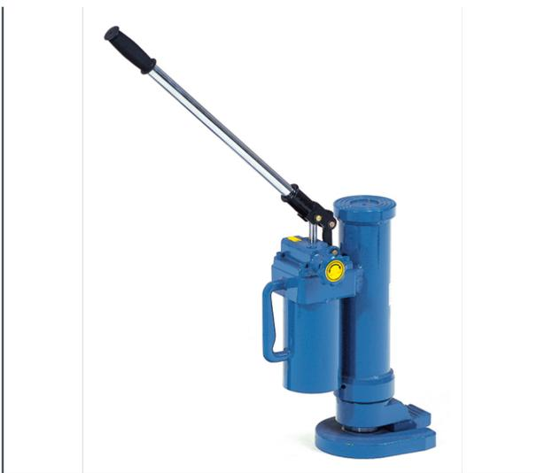
Maschinenheber zum Heben mit Hubklaue und Kopfplatte und durch eingebaute Hand-Hydraulikpumpe mit wenig Kraftaufwand möglich. Feinfühliges Senken über Senkventil, Überlastventil. Pumphebel abnehmbar. Das Gehäuse ist um 360° drehbar, in jeder Lage einsetzbar. Stabile Stahl-Kompakt-Konstruktion, Beschichtung blau RAL 5007. Hubbereich an Hubklaue 6932: 30-260 mm; Hubbereich an Kopfplatte 6932: 420-650 mm.
